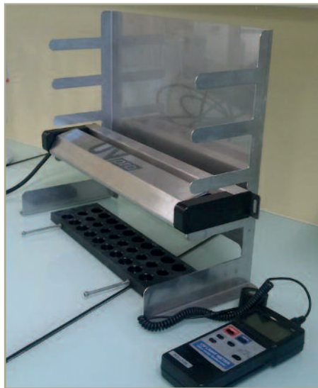
Abb. 1: UVC-Bestrahlungseinheit und UVC-Messgerät. Die Früchte wurden in die Vertiefungen des Trägers eingelegt und unter die UVC-Quelle geschoben.
