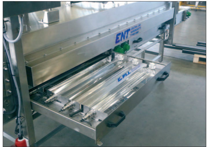
Abb. 4: Die unteren Strahler können durch ein Schubsystem seitlich herausgezogen werden. Die einfache Reinigung und Wartung sind Voraussetzung für eine gleichbleibende Entkeimungsleistung. Induktionsschalter sorgen für die Betriebssicherheit.
