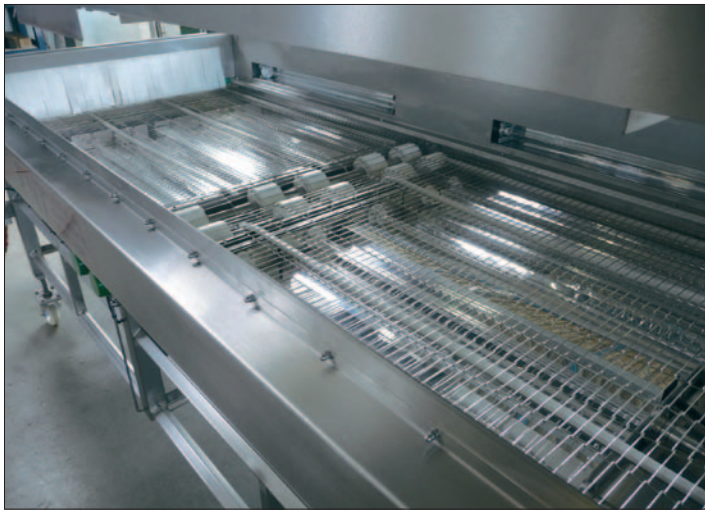
Abb. 3: Details bei angehobener Strahlerhaube. Das grobmaschige Gliederband ermöglicht einen Transport der Beutel mit optimaler Ausleuchtung. Die Übergabe der Beutel durch die Zweiteilung der Transporteinheit vermeidet Beschattungsstellen. Seitliche Strahler sorgen für eine homogene Ausleuchtung, auch der Beutelkanten.
