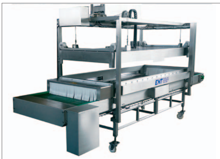
Abb. 2: Gesamtansicht des UVC-Tunnels. Bei geöffneter Haube können alle Bereiche der ca. 4 m langen Anlage problemlos gereinigt werden. Der Einsatz von Tauchstrahlertechnik ermöglicht bei Bedarf auch eine Nassreinigung.
