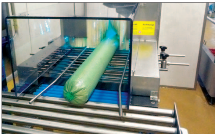
Abb. 5: Eindeutige rechtliche Grenzen für die UVC-Entkeimung gibt es bei Fleischwaren. Die Entkeimung der Oberfläche von Wurst vor der Verarbeitung ist nur bei UVC undurchlässiger Pelle vor dem Pellen zugelassen.
