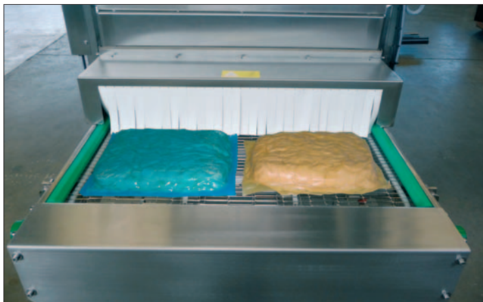
Abb. 1: Vorgekochte Kartoffelscheiben, steril eingeschweißt am Eingang des UVC-Entkeimungstunnels. Nach 20 s Durchlauf können die Beutel keimfrei entnommen werden. Ein zweireihiger Kunststoffvorhang schützt das Bedienpersonal vor den UVC-Strahlen.
