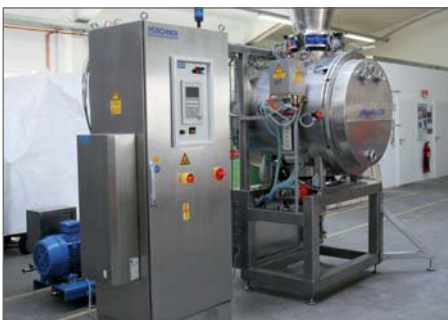
12kW/2450MHz μWaveVac1290. Mikrowellen Vakuum Batch Trommel Trockner für Nahrungsmittel, pharmazeutische und chemische sowie BioTec-Anwendungen.
