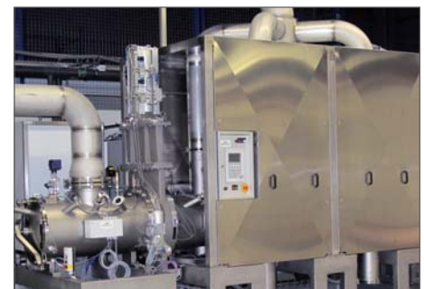
24kW/2450MHz μWaveVac2455. Mikrowellen Gefrierdryinganlage auf Basis von Werkzeugträgern über Ein- und Austragsschleuse.
