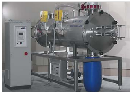
12kW/2450MHz μWaveVac1295. 2 Etagen Mikrowellen Vakuumbandtrockner mit kontinuierlicher Ein- und Austragsdosierung.
