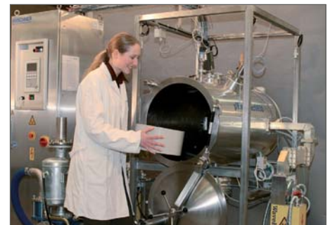
6kW/2450MHz μWaveVac0650. Mikrowellen Vakuum Pilot Trockner mit Drehteller und Trommelkonfiguration.
