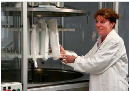
12kW/2450MHz μWaveVac1212. Mikrowellen Vakuum Karussell Trockner für medizinische Einwegartikel.
