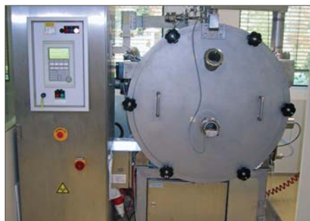
2kW/2450MHz μWaveVac0290. Mikrowellen Kombinationstrockner mit Umluft und Vakuum unter ExSchutz und cGMP.
