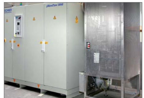
100kW/915MHz \mu WaveFlow10040react. Flow Reaktor für Durchsätze von 500l/h (35bar/300°C).
