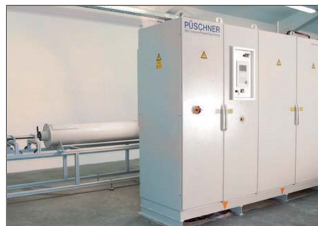
100kW/915MHz \mu WaveFlow10040. Flow Erhitzer zur ultra-schnellen Erhitzung eines viskosen Produktes vor einem Sprühtrockner (16bar/250°C).
