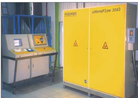
30kW/915MHz \mu WaveFlow3040. Flow Erhitzer zur Pasteurisation von Fruchtpulpen und Haselnusspasten in der Nahrungsmittelindustrie.
