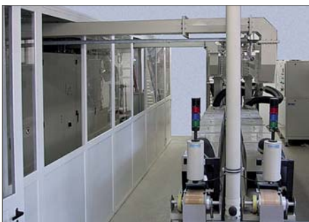
2x30kW/915MHz µWaveDryer3050 zur ppm Trocknung von Feinchemikalien
