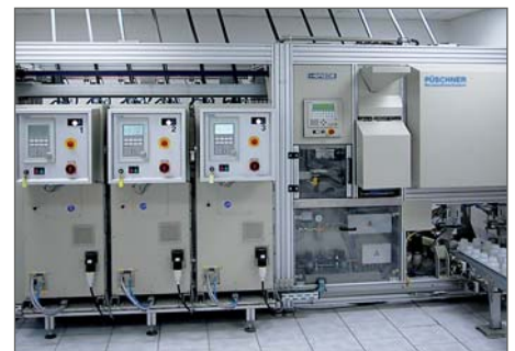
3x1kW/2450MHz Kammetrockner für Probenaufbereitung in der Minenindustrie
