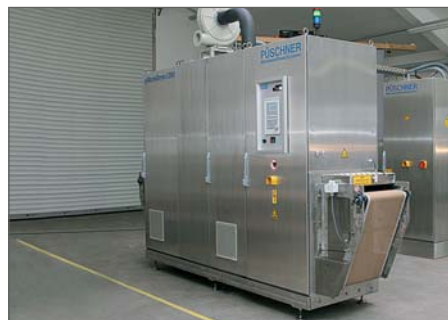
12kW/2450MHz µWaveDryer1205 zur Trocknung von Lebensmitteln in Kombination mit Heißdampf und Infrarotheizung
