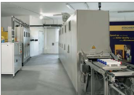
48kW/2450MHz µWaveDryer4805 zur kontinuierlichen Trocknung von Filtern auf Werkzeugträgern
