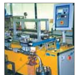
Hochdruck Durchlauferhitzer zur thermochemischen Behandlung viskoser Stoffgemische (250bar/400°C)
