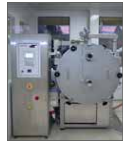
µWaveVac0290, Kombinationstrockner Luft/Vakuum unter ExSchutz und cGMP
