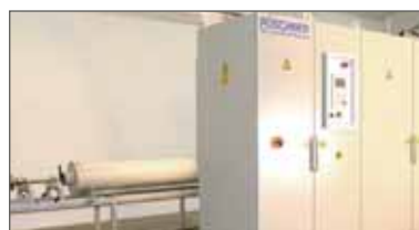
µWaveFlow10040, 100kW/915MHz Flow-Reaktor zur Reaktionsbeschleunigung in der chemischen Industrie
